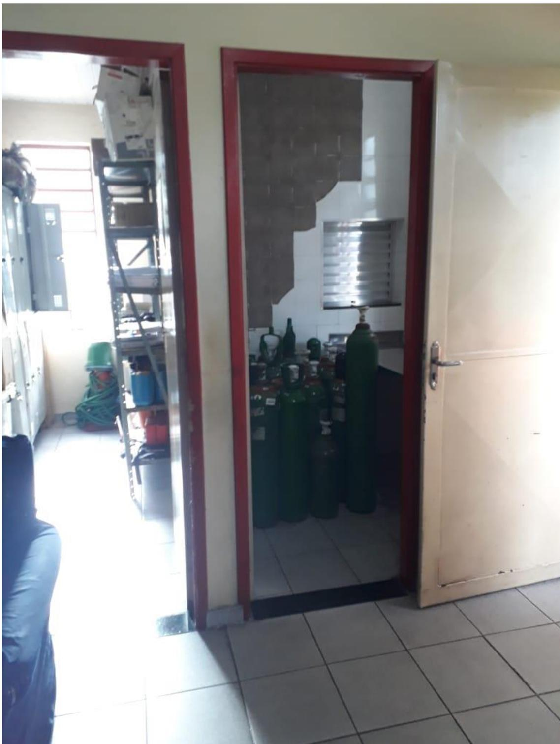
Figura 24: Ponto de Assistência na AMA Juscelino Kubitschek, onde há o armazenamento inadequado de cilindros de oxigênio, colocando todos trabalhadores em risco por explosão.
